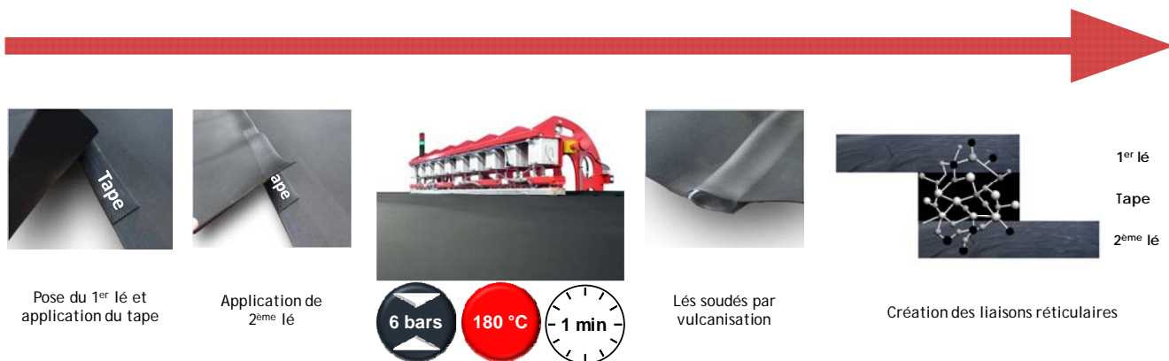
Figure 1 – Processus d'assemblage en usine par vulcanisation à chaud d'un tape élastomère EPDM cru
