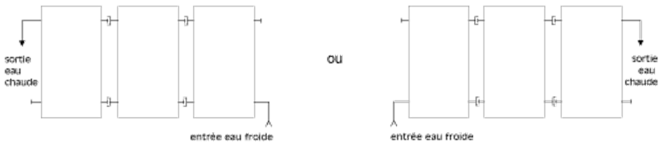
Figure 7 – Raccordement des capteurs : exemple avec 3 capteurs
