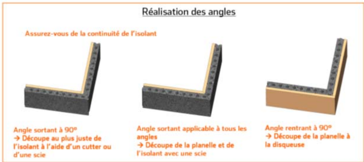
Figure 17 Réalisation des points singuliers des planelles « ISOPLANEL »
