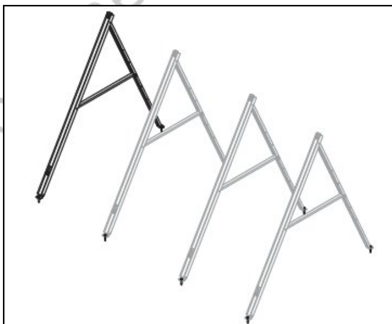
Figure 17.3 – Mise en œuvre des châssis par vissage direct dans la structure du bâtiment (plots béton).
