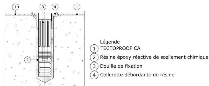
Figure 45 – Scellement direct par collerette
