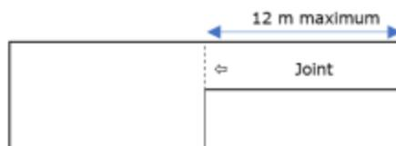
**Figure 2b – Fractionnement de la chape dans le cas des planchers chauffants – angle rentrant**
