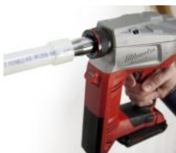
Figure 7 - Réalisation des assemblages
