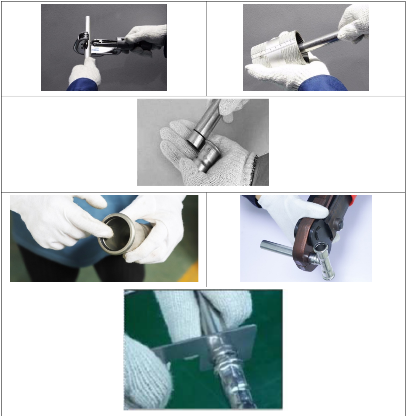
Figure 2 - Réalisation de l'assemblage
