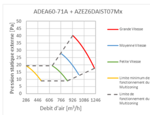
Figure 10 – Unités intérieures ADEA60A et ADEA71A Courbes débit/pression
