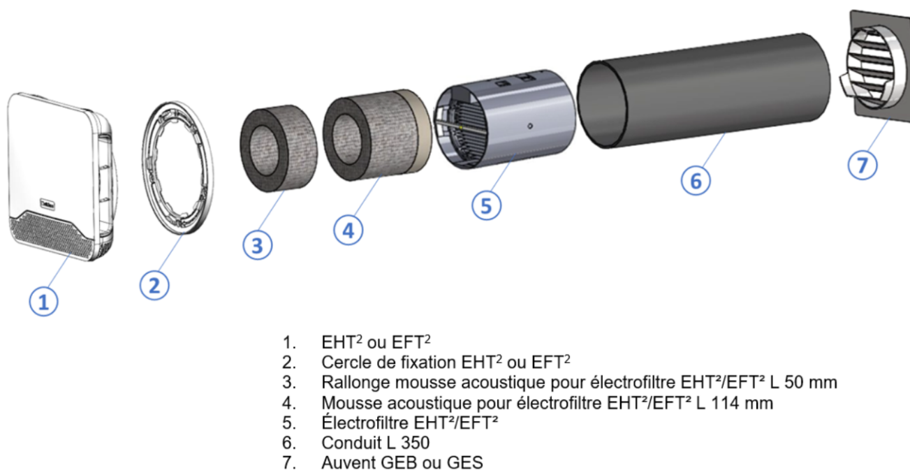
Figure 22 – Mise en œuvre entrée d'air EHT² avec électrofiltre EHT²/EFT² Ø 125 mm L 350 mm
