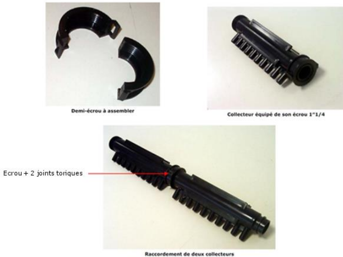
Figure 5 – Assemblage des collecteurs en ABS.
