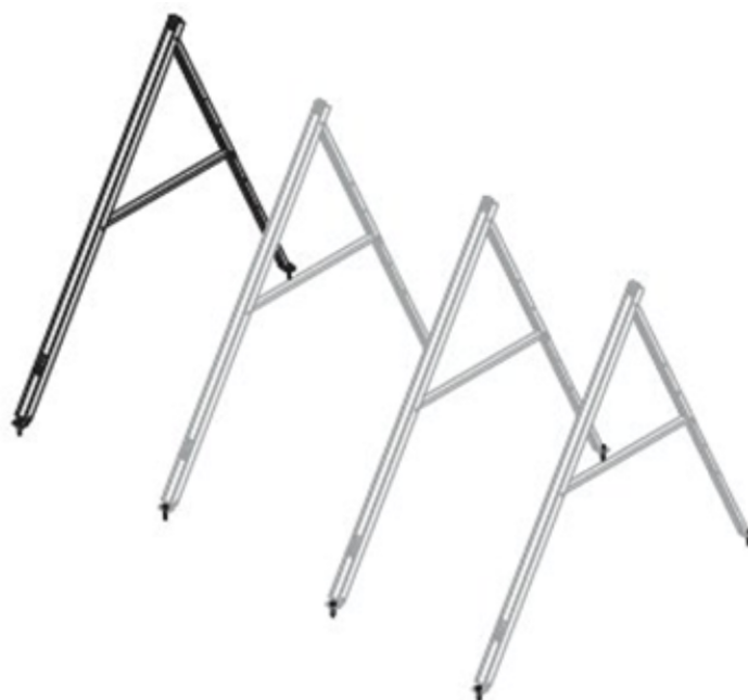
Figure20 – Mise en œuvre des châssis par vissage direct dans la structure du bâtiment (plots béton)
