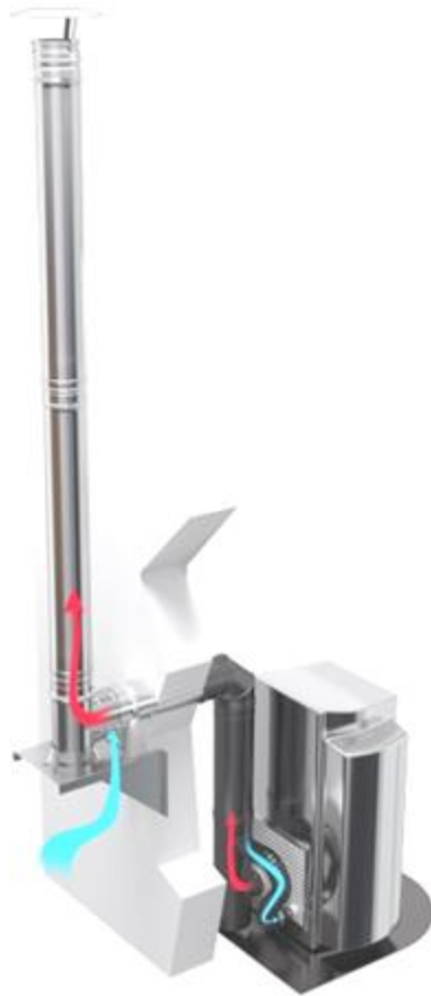
Figure 7 - Configuration séparée : Raccordement concentrique et conduit isolé en situation extérieure (poêles à granulés)
