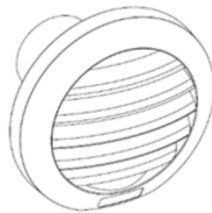
Figure 15 – Auvent EHT 2 /EFT 2
