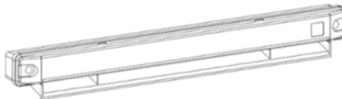
Figure 11 – Auvent acoustique AAA
