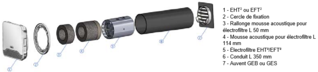
Figure 44 – Mise en œuvre entrée d'air EHT 2 et EFT 2 avec électrofiltre en conduit Ø 125 mm L 350 mm
