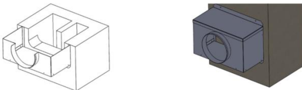
Figure 24 – Schéma de principe d'un plénum en piquage sur une face de la souche
