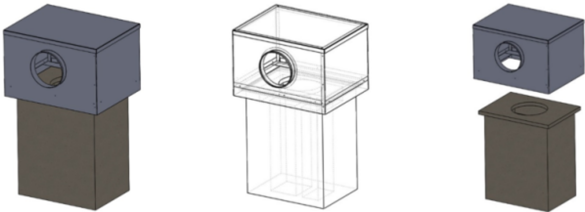
Figure 22 – Schéma de principe d'un plénum de recouvrement avec goutte d'eau en cas de conservation de la dalle existante
