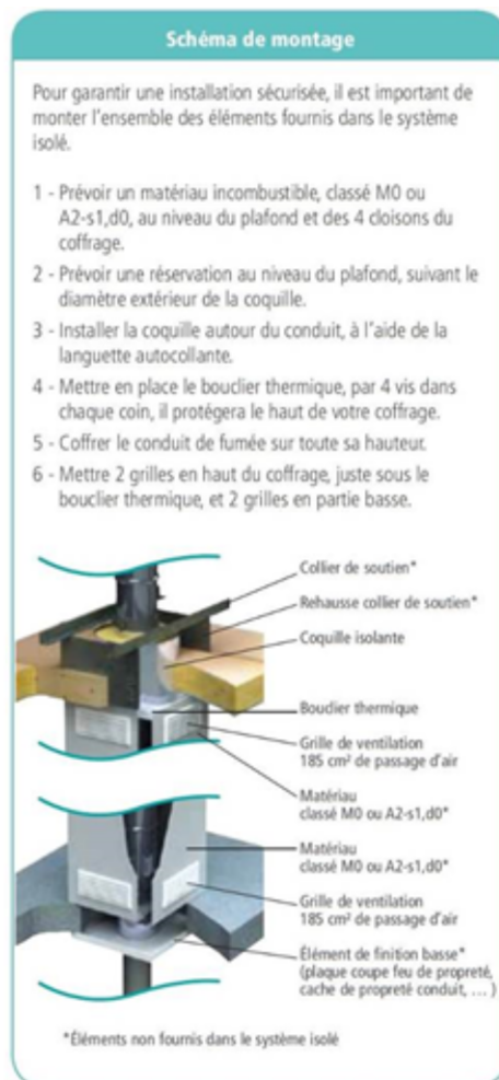
Figure 10 – Schéma de montage du système isolé
