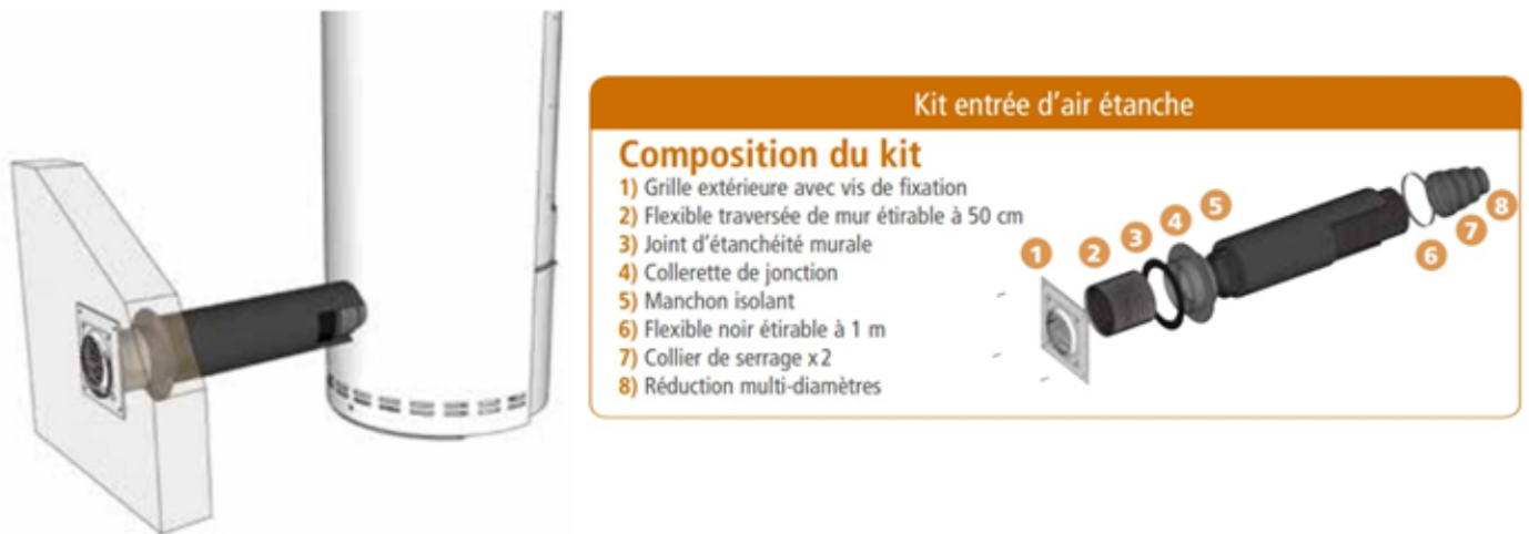
Figure 8 – Kit entrée d'air étanche
