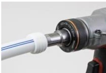
L'utilisation de la pince électroportative est décrite dans la notice de l'appareil. Elle simplifie la séquence d'expansion du tube avec sa bague.
