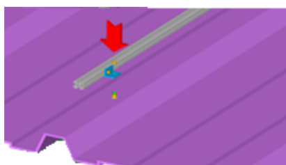
Pose des rails C et équerres D sur les points d'ancrage sur le toit
