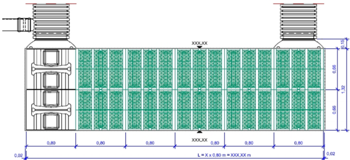
Figure 8b – Coupe de principe d'un bassin réalisé avec Rigofill inspect et sa boîte d'inspection intégrée
