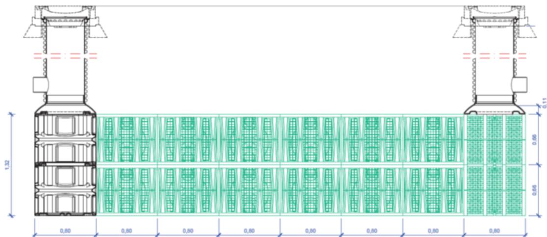
Figure 11b – Coupe de principe d'un bassin réalisé en mix Rigofill inspect et ST-A avec boîte d'inspection intégrée
