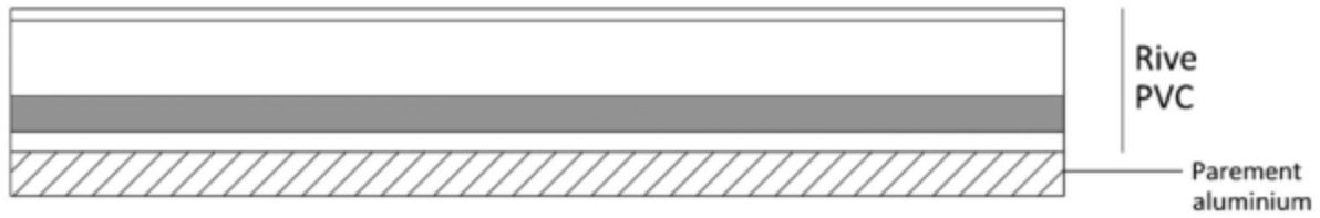
1. Coupe horizontale > Pose horizontale Panneau avant façonnage
