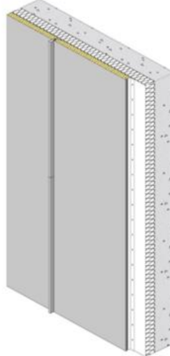
4 – Mise en place du panneau suivant Profils joint debout insérés entre les panneaux MYRAL
