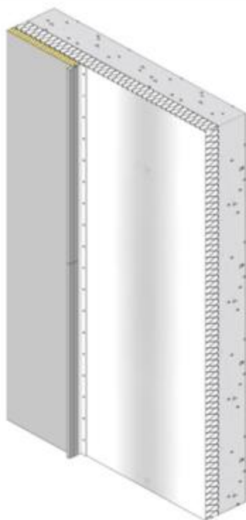
3 – Mise en place du profil joint debout supérieur Le guide permet d'aligner les deux profils joint debout.
