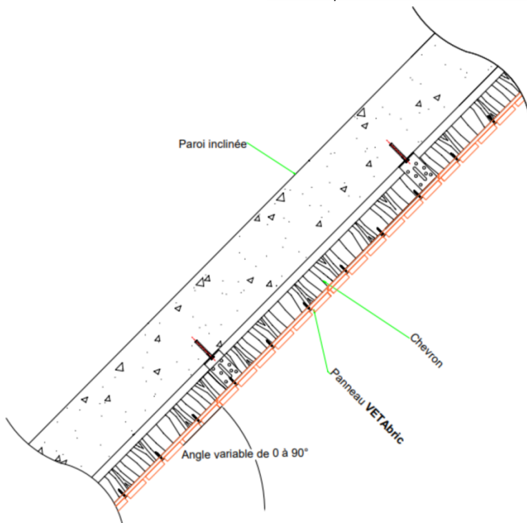
Figure 43 – Pose sur paroi inclinée ou en sous-face
