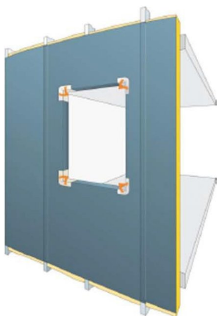
Etape 7 : l'adhésif est rabattu sur la membrane en partie courante
