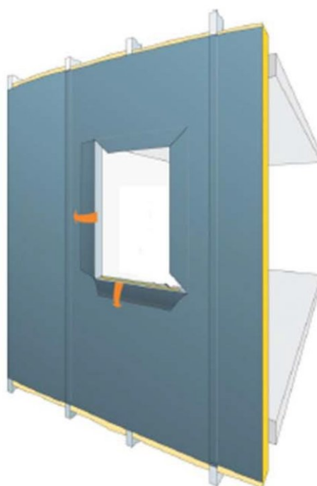
Etape 4 : Découpe des rabats aux angles suivant un angle de 45°.
