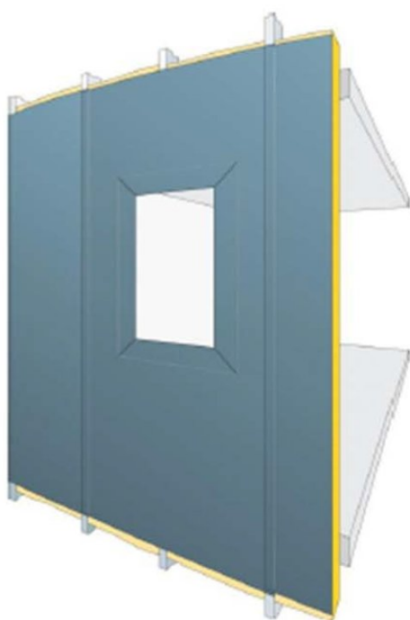
Etape 3 : La partie centrale est enlevée
