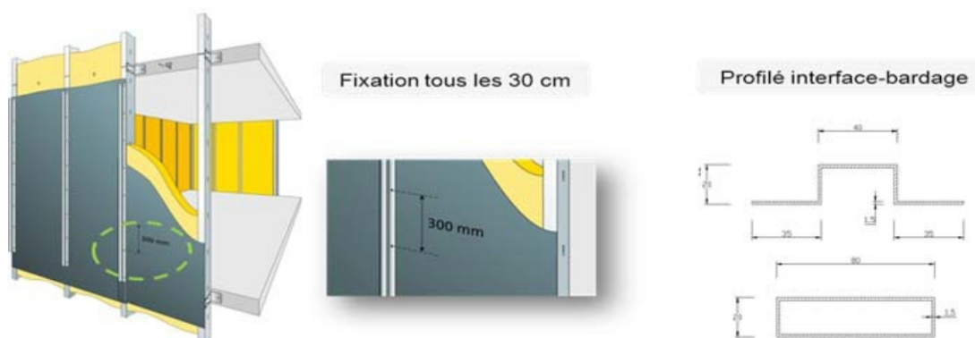
Figure 43 - Figure PAP3 Pas à Pas du montage des ouvertures pour les bâtiments de hauteur supérieure à R+4
