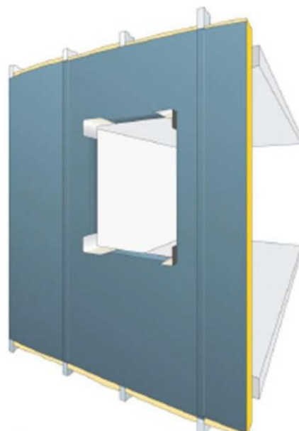
Etape 6 : l'adhésif est appliqué dans chaque angle. Il dépasse de 5 cm du chevêtre
