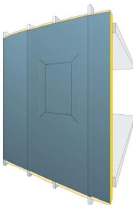
Etape 2 : Pose du pare-pluie
