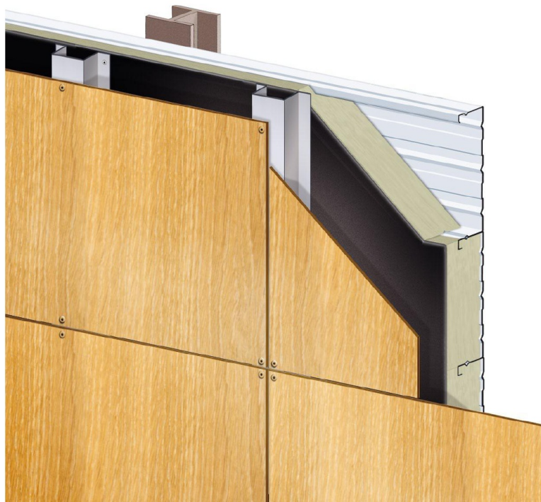
Figure 2 – Schéma de principe avec pare-pluie synthétique
