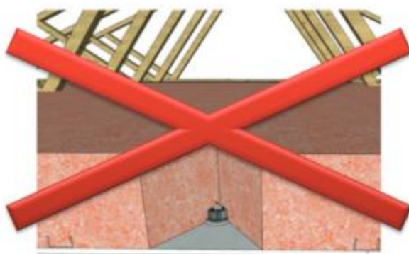
Figure 4 – Spot non protégé au contact de l'isolant interdit
