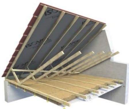
Figure 5.3 - Pose de la membrane pare-vapeur
