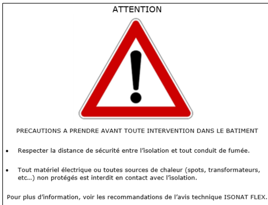
Figure 8 - Étiquette à appliquer sur les tableaux électriques
