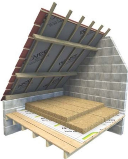
Figure 6.3 - Pose de la seconde couche d'isolant ISONAT FLEX en joints décalés
