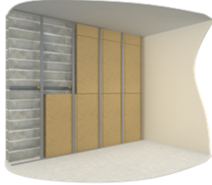
Figure 1-1 - Insertion des panneaux ISONAT FLEX derrière l'ossature métalliques
