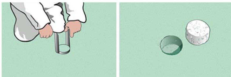
Figure 12 : Prélèvement des éprouvettes par carottage
