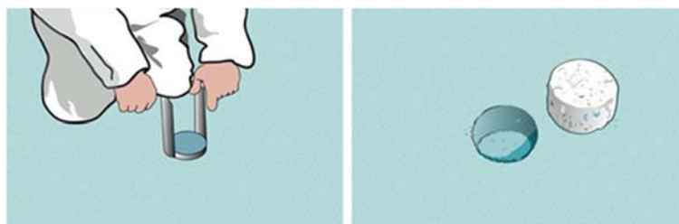
Figure 12 : Prélèvement des éprouvettes par carottage
