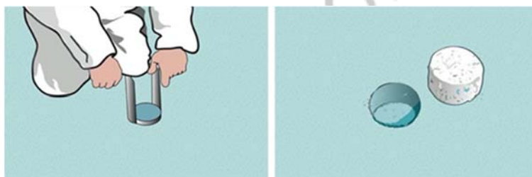
Figure 12 : Prélèvement des éprouvettes par carottage
