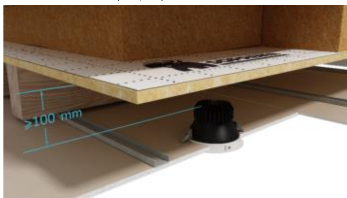
Figure 3. Spot encastré dans un plénum
