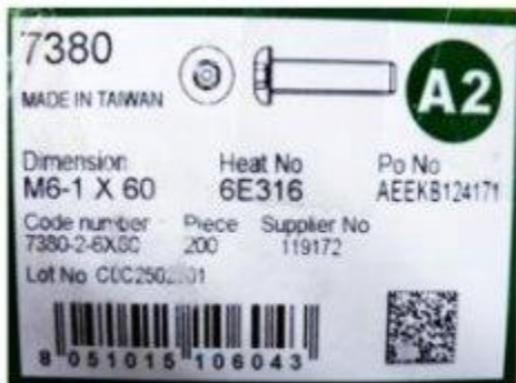
Vis tête bombée M6 x 60 : Vis pour parclose
