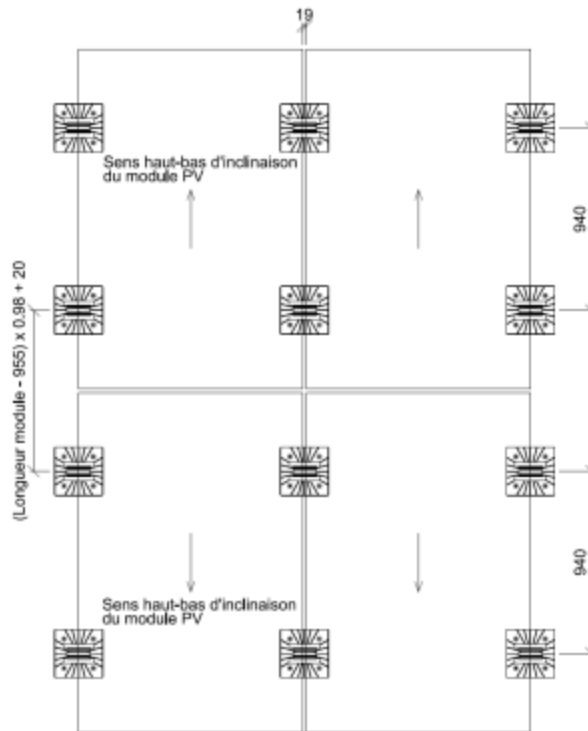
Figure 24 : Implantation des plots SOPRASOLAR FIX EVO avec modules photovoltaïques en inclinaison double shed - réhausse polymère
