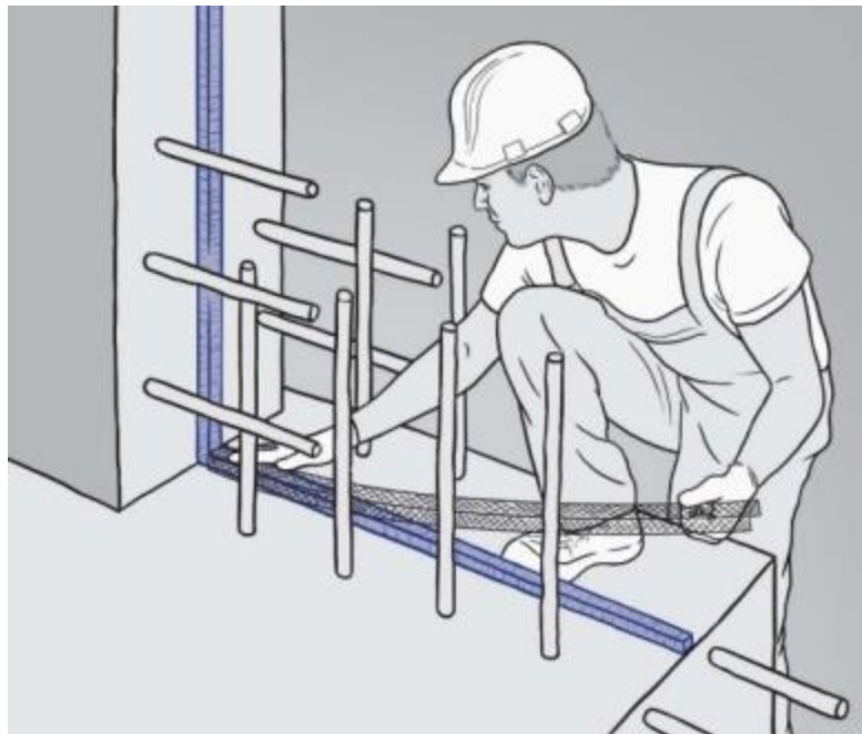
Figure 3 - Poser la grille de la fixation WIRE MESH sur le BENTOBAR +
