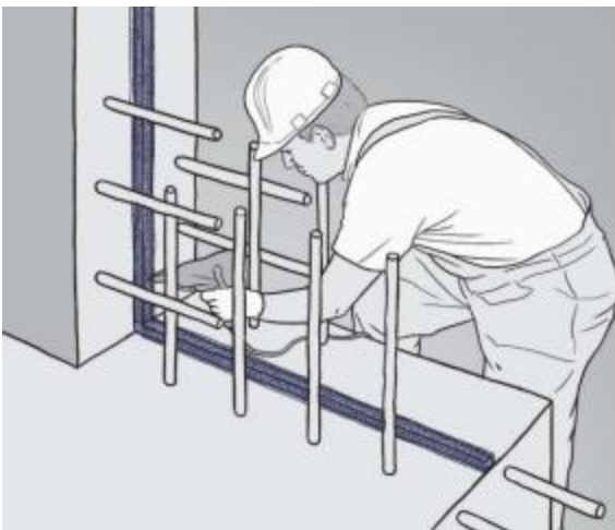
Figure 4 - Clouer tous les 25cm pour garantir un bon contact du « BENTOBAR + »
