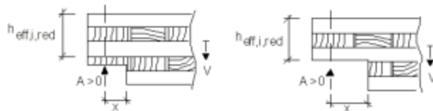
Figure 3 : Définition de la hauteur efficace pour un appui entailé
