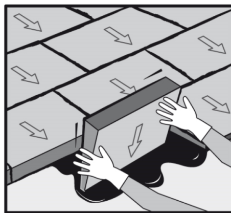
Figure 4b : Juste avant leur mise en place, deux des tranches des panneaux FOAMGLAS TAPERED ou FOAMGLAS TAPERED READY sont trempées dans le bitume.
