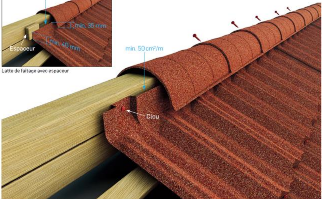
Latte de faitage avec ventilation
