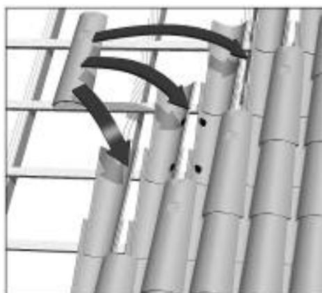
Figure 20 - Pose sur liteaux - Tuiles de couvert en partie courante - Collage
