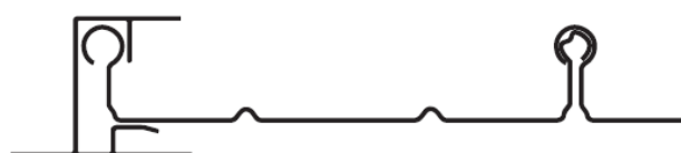
Figure 8 bis – Profil de rive tout-en-un avec R > 100 m : hauteur 50 pour les profils de type Kalzip® 50, AF 65 ou AS 65, hauteur 65 pour les profils de type Kalzip® 65
