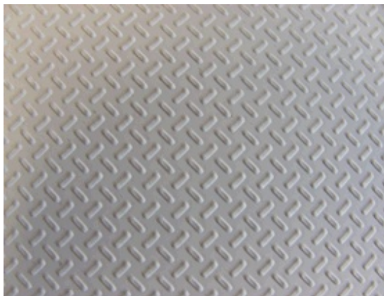
Figure 2 – Surface texturée du chemin de circulation Sarnafil® TG 20 WW
