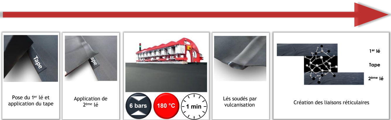
Figure 1 – Processus d'assemblage en usine par vulcanisation à chaud d'un tape élastomère EPDM cru
