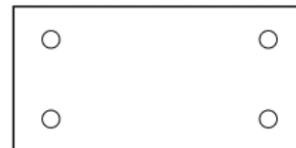
Figure 1a : Panneaux de dimensions 1200 × 600 mm - plans de chevillage « en plein » (espacement entre chevilles ≥ 150 mm)
