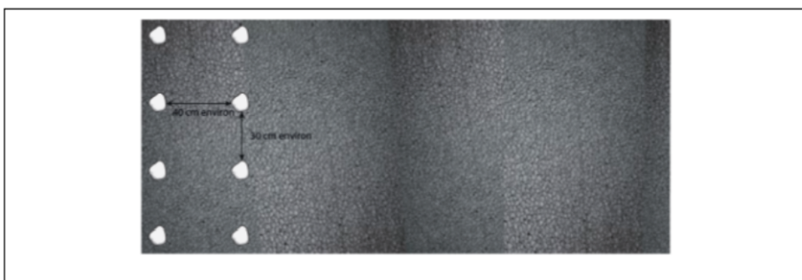
Figure 1 – Mode de collage : Collage en plots - répartition des plots de Map® Formule +
