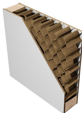
Figure 5 : Porte à âme alvéolaire
