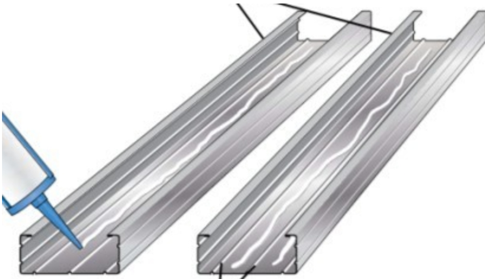
Figure 1 - Mise en œuvre colle sur fourrures Up Stil®
