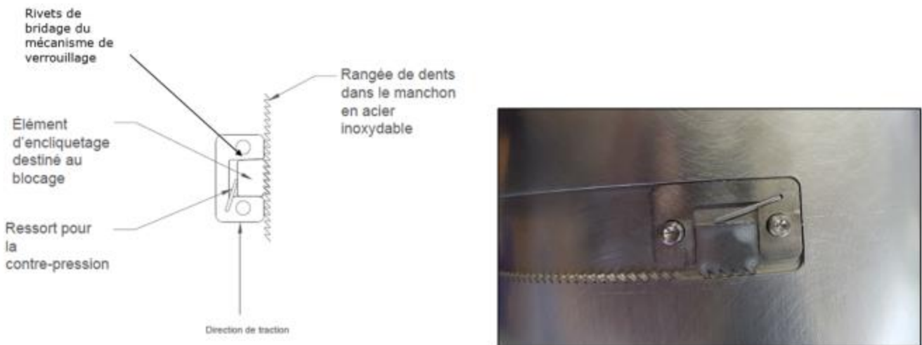
Figure 3 : Schéma de principe et plan du mécanisme de blocage
