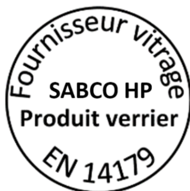
Figure 20 – Exemple de marquage sur le verre
