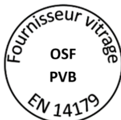
Figure 1 – Exemple de marquage sur le verre
