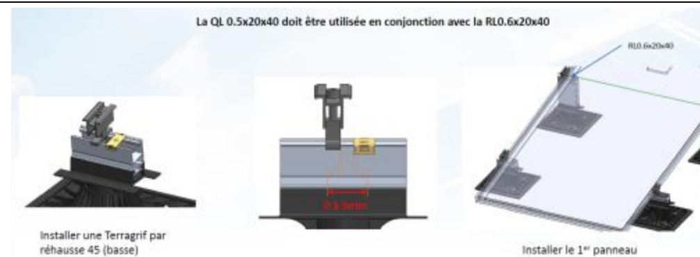
Système de mise à la terre Terragrif de Mobasolar (QL0.5x20x40 + RL0.6x20x40) des modules et rehausse aluminium
