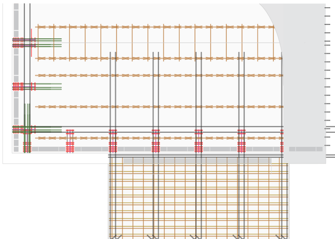
Figure 3 : vue en plan - balcon perpendiculaire au sens de portée
