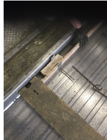
Figure 17 : Fabrication des Prédalles équipées de sabots sens non porteur
