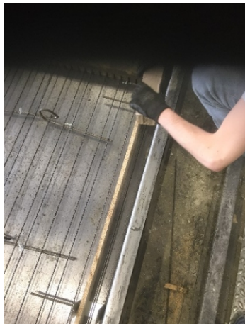
Figure 17 : Fabrication des Prédalles équipées de sabots sens non porteur
