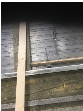
Figure 17 : Fabrication des Prédalles équipées de sabots sens non porteur
